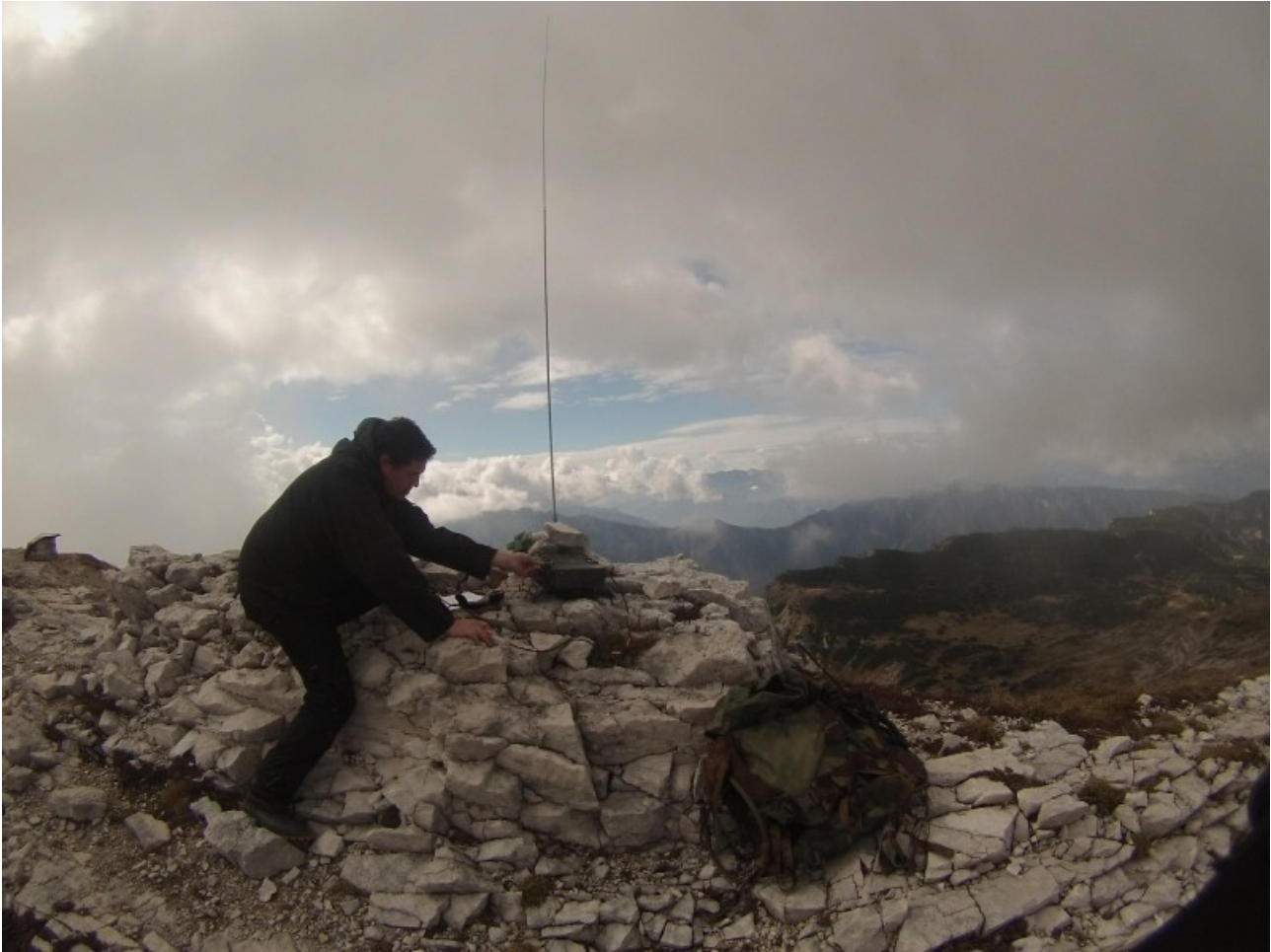
Stazione radio con PRC 320 e stilo 5m
